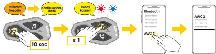
Kopplung des zweiten Handys (bei eingeschaltetem Gerät)
