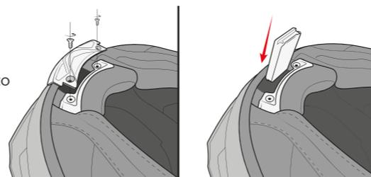
Ejemplo de colocación de la batería en cascos sin compartimento interno
