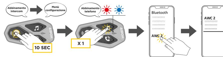
I sistemi multimediali TFT delle moto, vanno abbinati come primo telefono:
