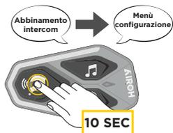
Con AWC 2 acceso, entrare nel menù di configurazione, premendo per 10 secondi il tasto di accensione. Attenzione non lasciare il tasto prima che il led diventi blu, si ascolterà il messaggio di conferma dell'attivazione del menù configurazione.
