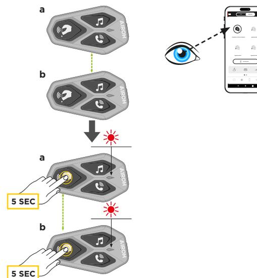
**L'abbinamento è necessario solo la prima volta, successivamente le centraline si riconoscono automaticamente.**
